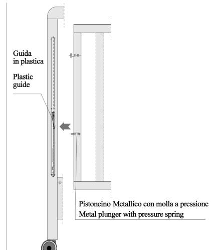
**A** Inserire il **Perno in Metallo** presente sul lato della **Sponda Mobile** nella **Guida di scorrimento** in plastica situata lungo la gamba della **Testata**, tenendo rialzato il lato opposto della sponda.
