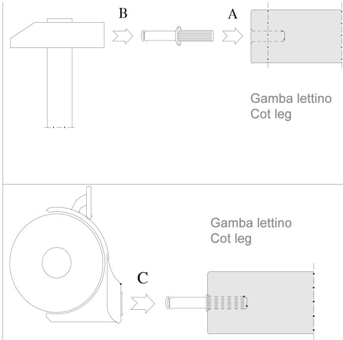
**A** Inserire il **Perno Ruota** (7) nel **foro** della gamba del lettino.
